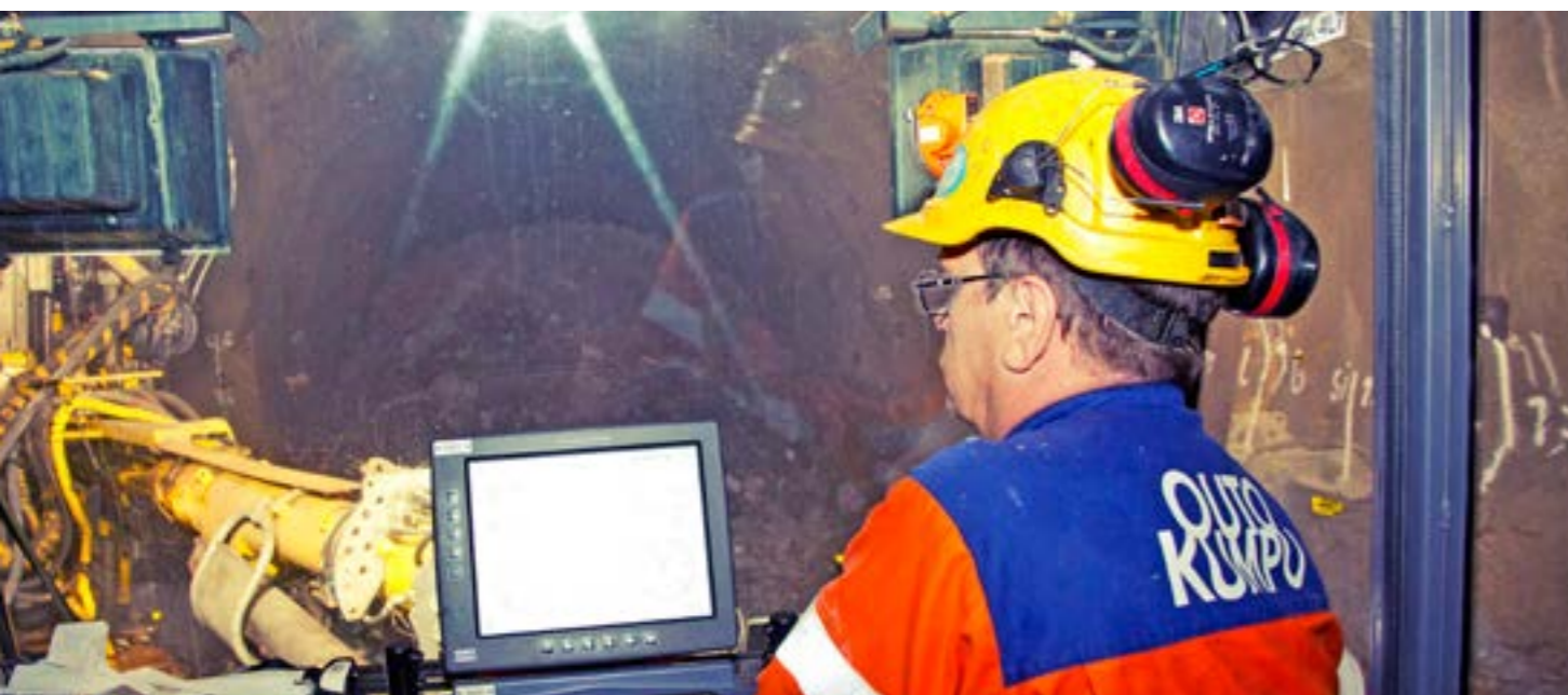
Pitkäreikäporausta Kemin kaivoksen maanlaisessa kaivoksessa. Kuva: Outokumpu Chrome Oy
