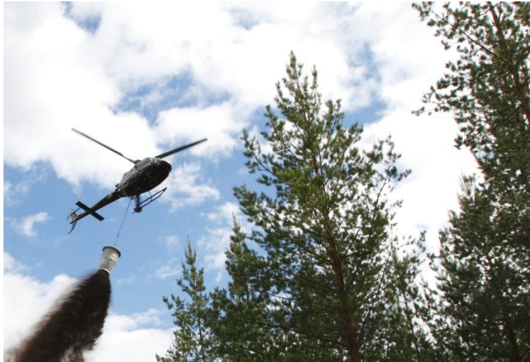
Kuva 8. Helikopteri levittämässä valmista tuhista valmistettua lannoitetta metsään.
